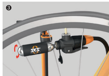
3 De CO2 uit de patroon laten lopen door voorzichtig uitdraaien.
