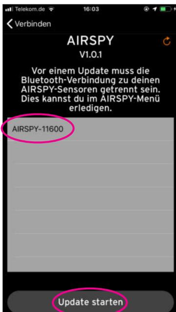
Wird ein Sensor mit dem Namen TPMS\_DFU angezeigt, wurde das Update nicht vollständig durchgeführt. Bitte wählen Sie diesen Sensor aus und führen das Update erneut durch. Danach wird der Sensor wieder unter seiner Seriennummer erkannt.
