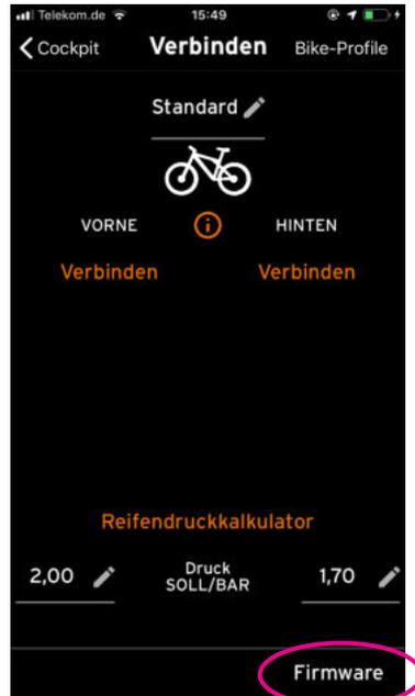
Wählen Sie die AIRSPY-Sensoren nacheinander aus und starten Sie das Update. Bevor das Update der AIRSPY-Sensoren gestartet werden kann, muss eine gegebenenfalls aktive Verbindung der Sensoren mit dem Smartphone getrennt werden.
