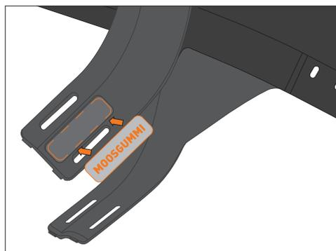
Coller le caoutchouc mousse sur le garde-boue (à l'extérieur)
