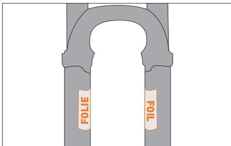
Fixer le film de protection du cadre au tube plongeur.
