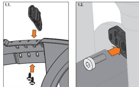
1.1. Visser l'adaptateur sur le garde-boue en fonction du schéma de trous requis. Utiliser les vis autotaraudeuses fournies à cet effet. (TX20)
