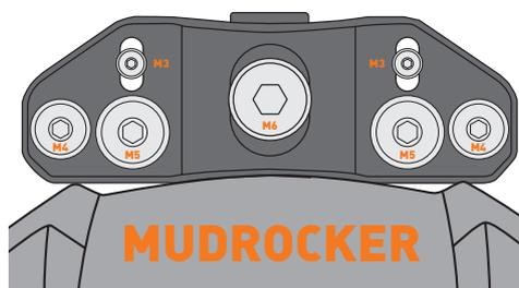
L'adaptateur de fourche MUDROCKER FRONT peut être fixé de différentes manières sur le pont de fourche. Veuillez vérifier au préalable si les options de trous disponibles correspondent à celles de votre fourche. L'adaptateur doit être fixé au minimum à l'aide de la vis M6 au centre ou de 2 vis latérales. L'adaptateur peut également être utilisé tourné de 180 degrés. Il faut veiller à respecter la distance minimale par rapport au pneu, même lorsque la suspension est comprimée.
