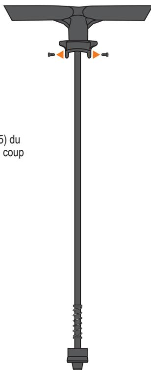
2. Retirez l'ancienne rondelle. Si nécessaire, utilisez un outil (par ex. un tournevis).
