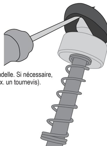
3. Enfilez la nouvelle rondelle sur la tige de piston jusqu'à ce qu'elle soit placée dans le joint prévu à cet effet.
