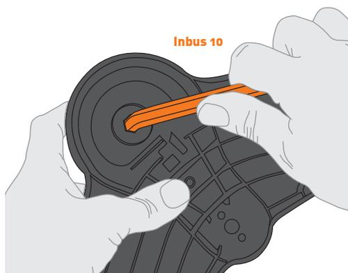
4. Tournez le support du manomètre d'env. 45° dans le sens inverse des aiguilles d'une montre jusqu'à ce qu'une résistance soit ressentie. Retirez ensuite le support du manomètre.
