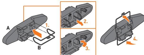
**02 FR** Placer le support du feu arrière (A) sur le porte-bagages monté. Les boulons du support (A) doivent s'engager dans les trous du porte-bagages. **Remarque.** Respecter l'orientation.
