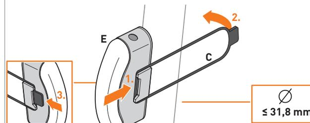
**04 FR** Monter le feu arrière (E) sur le porte-bagages à l'aide des boucles de la bande élastique (B). **Remarque.** Veillez à ce que la bande élastique soit correctement positionnée.
