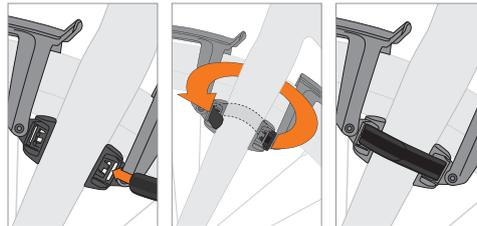
**04 FR** Placer également les adaptateurs de fixation sur la fourche du vélo avec les films de protection. Déplacer la tringle dans la bonne position en fonction de la taille du cadre (1) puis la serrer sur l'adaptateur (2).
