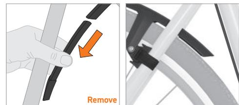
**07 FR** profil d'extension doit être retiré. Dans le cas contraire, la fixation risque d'endommager le câble.
