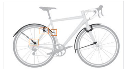
FR . Montage des inserts en caoutchouc et fixation avec des bandes velcro
