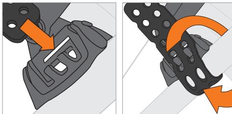
**03 FR** Mettre le SPEEDROCKER en position et, dans un premier temps, le fixer au tube de selle. Pour ce faire, enfiler la bande velcro **B** au-dessus du film de protection, côté caoutchouté face au tube de selle, et la serrer. Au besoin, faire glisser le profilé d'extension télescopique dans la bonne position.
