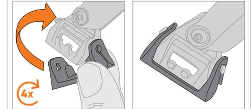
**02 FR** Placer le SPEEDROCKER sur le cadre du vélo et l'aligner grossièrement. Ensuite, retirer une nouvelle fois le SPEEDROCKER et coller le film de protection **D** fourni sur le cadre au niveau des points d'appui.
