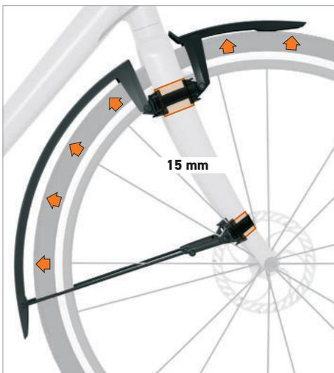
**03 FR** Positionner l'adaptateur de fixation du SPEEDROCKER sur le film de protection. Enfiler la bande velcro **A**, côté caoutchouté face au cadre, et la tirer fermement.
