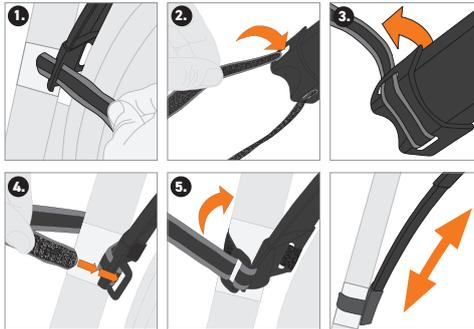
**04 FR** Positionner l'adaptateur de fixation du SPEEDROCKER sur le film de protection. Ensuite, enfiler les bandes en caoutchouc **B** jointées à travers l'ouverture de l'adaptateur et les tirer vers l'avant. Puis les fixer à l'aide des œillets.
