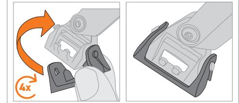
**02 FR** Placer le SPEEDROCKER sur le cadre du vélo et l'aligner grossièrement. Ensuite, retirer une nouvelle fois le SPEEDROCKER et coller le film de protection **D** fourni sur le cadre au niveau des points d'appui. Remarque. Le support doit être propre et exempt de graisse.
