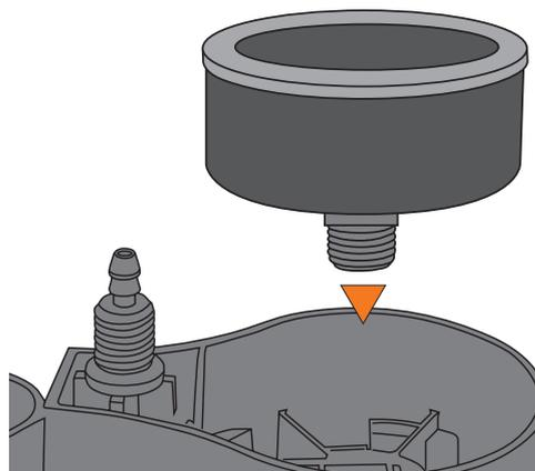
5. Manometer mit max. 2Nm anschrauben.
