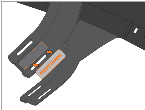
Moosgummi an Radschutz kleben (außen)
