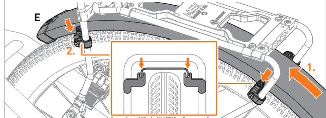
**02 DE** Radschutz Aufnahme (B) mit Mutter (C), Schraube (D) und dem Schlüssel (G) an Strebenklemme handfest anschrauben.
