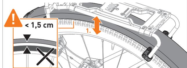
**05 DE** Schraube (D) mit dem Schlüssel (G) an der Strebenklemme (A) fest anziehen und so die Position des Radschutzes fixieren.
