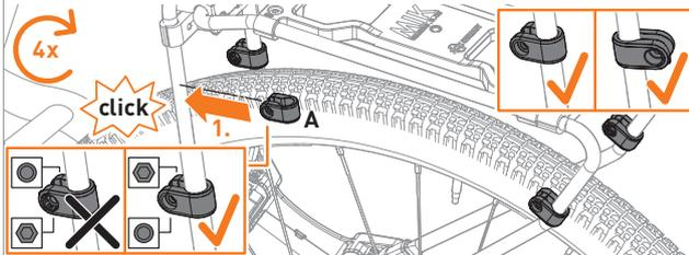
**03 DE** Radschutz (E) in die montierten Radschutz Aufnahmen einsetzen.
