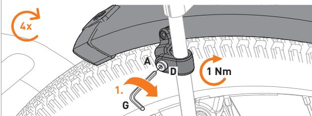
**07 DE** Sichtkontrolle. Prüfen Sie den Abstand des Radschutzes zum Hinterrad sowie den Freilauf des Rades.
