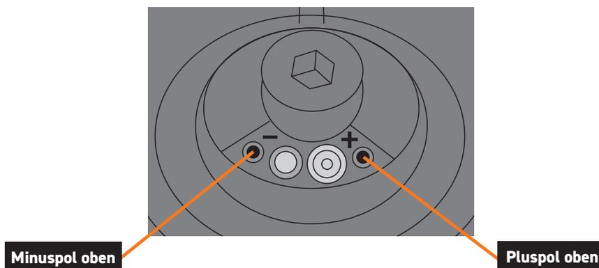
4. Schrauben Sie anschließend die Batteriefachabdeckung wieder zu. (**ACHTUNG:** nur handfest anziehen.)
