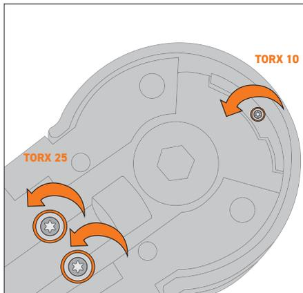
2. Torx-Schrauben lösen
