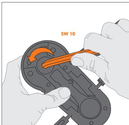
5. Manometer an der Unterseite mit Innensechskantschlüssel (10) herausschrauben
