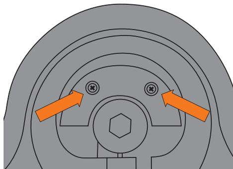
3. Heben Sie die Batteriefachabdeckung ab und ersetzen die Batterien (2 x 1.5 V AAA). Achten Sie beim Einsetzen unbedingt auf die Plus- und Minus-Zeichen am Rand des Batteriefachs. Setzen Sie die Batterien so ein, dass auf der Plusseite der Pluspol und auf der Minusseite der Minuspol der Batterie nach oben zeigt.
