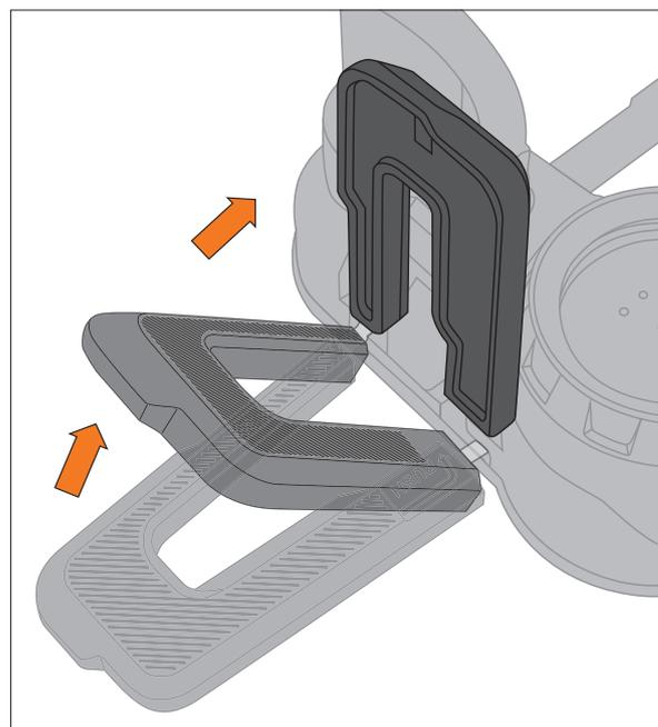
Anschließend den Fuß soweit nach oben drücken, bis dieser sich in der senkrechten Position befindet.
