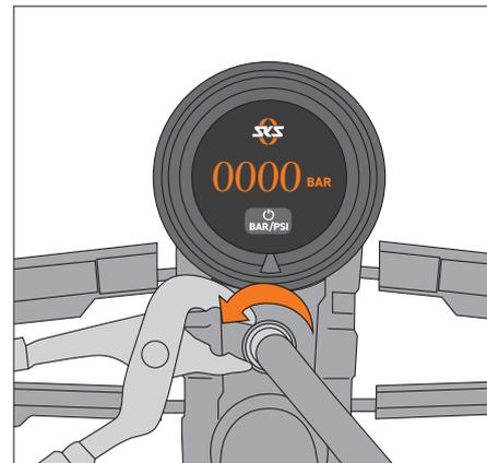
3. Verschraubung des Schlauches lösen
