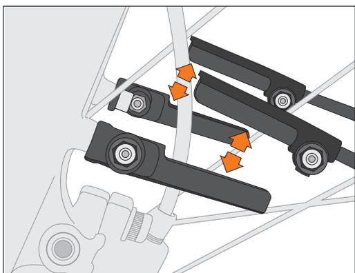
Das Escape-Sicherungssystem (ESC) verhindert ein Blockieren des Vorderrades, sollte sich mal ein Fremdkörper in dem Radschützer verfangen. Die Streben lösen sich in einen solchen Fall und können danach wieder eingesteckt werden.
