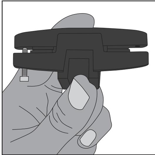
2. Das Klick-System im hinteren Bereich des Sattels anbringen und fest montieren.
