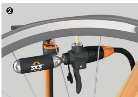
2 TL-HEAD auf das Ventil aufsetzen und Klemmhebel umlegen.
