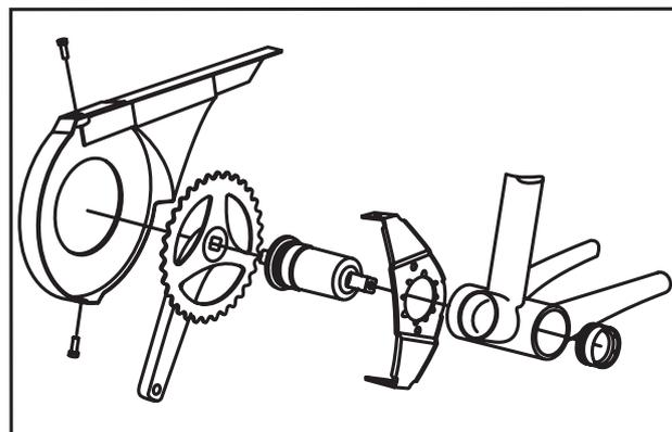
Zur Montage müssen Kurbel und Tretlager demontiert werden.
